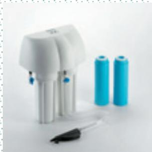
**Aquafilter** Dispositivo per la produzione di acqua deionizzata in conformità alla norma dalla norma EN13060 (< 15 us/cm). Riducendo i sali evita la formazione di incrostazioni sia all'interno della camera che sugli strumenti. È direttamente collegabile alla rete idrica, può alimentare ben due autoclavi E9 e la pistola erogatrice. Distilla 60 l di acqua all'ora. Dimensioni: 320x420x180 mm (LxHxP).
