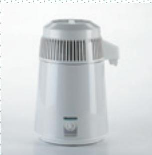
**Aquadist** Distillatore d'acqua che permette di ottenere acqua distillata per ebollizione e successiva condensazione del vapore. Distilla 0,7 l di acqua all'ora. Capacità 4 litri. Assolve alle prove di sicurezza e di compatibilità elettromagnetica (89/336/EEC) e bassa tensione (73/23/EEC).
